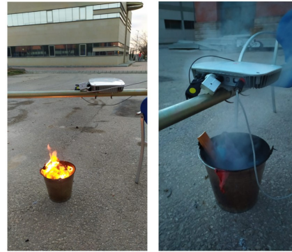
Fig. 5: Experimento llevado a cabo sin acelerantes (izquierda) y con acelerantes (derecha).
