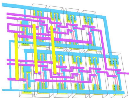
Fig. 4: Vista 3D de un multiplexador 4 a 1 en tecnología CMOS con Electric .
