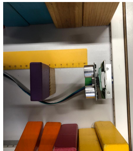
Fig. 8: Sensor ultrasonidos direccionado a 6.6 cm
