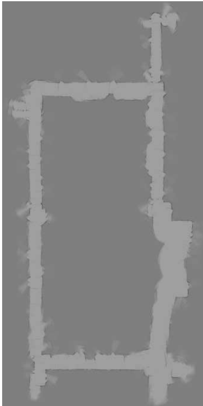
Figura 6.14: Mapa métrico global construido a partir de los diferentes mapas de obstáculos locales creados durante el trayecto de la figura 6.13. El alcance efectivo de los US es de tres metros.
