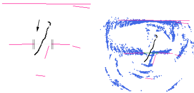
Figura 5.23: Cruce de una puerta: a) datos del láser y b) datos de US.
