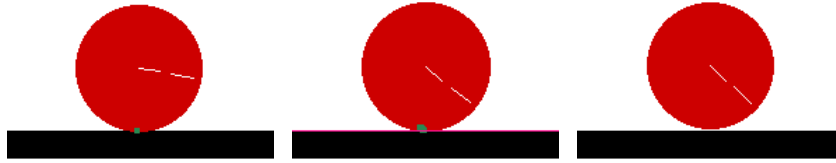
Figura 5.28: Funcionamiento del comportamiento ELUDIR_CONTACTO : (izquierda) detección del choque, (centro) giro y (derecha) retroceder.
