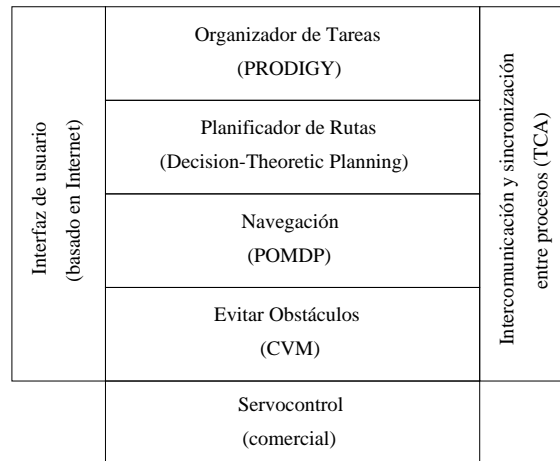
Figura 3.15: Arquitectura en capas basada en TCA (adaptado de (Simmons y col., 1997b; Koenig y Simmons, 1998)).
