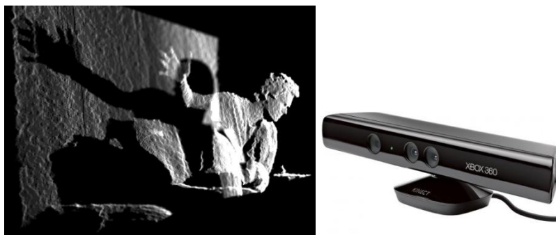
Ilustración 4. Nube de puntos adquirida en tiempo real con el dispositivo Kinect de Microsoft.
