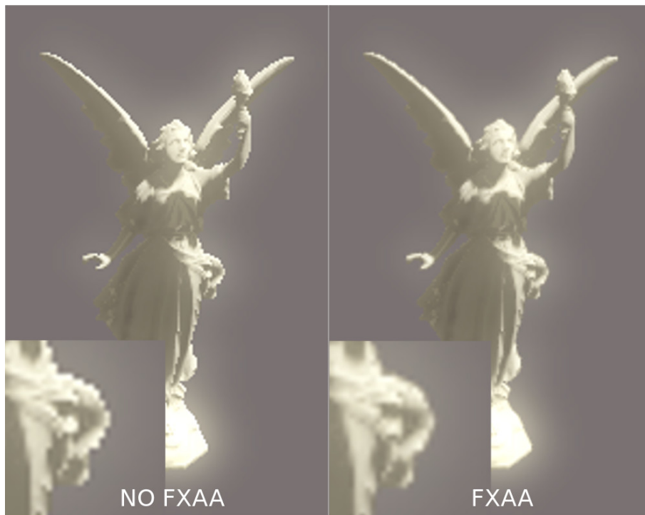
Figura 6.36: Comparación del efecto de anti-aliasing con FXAA
