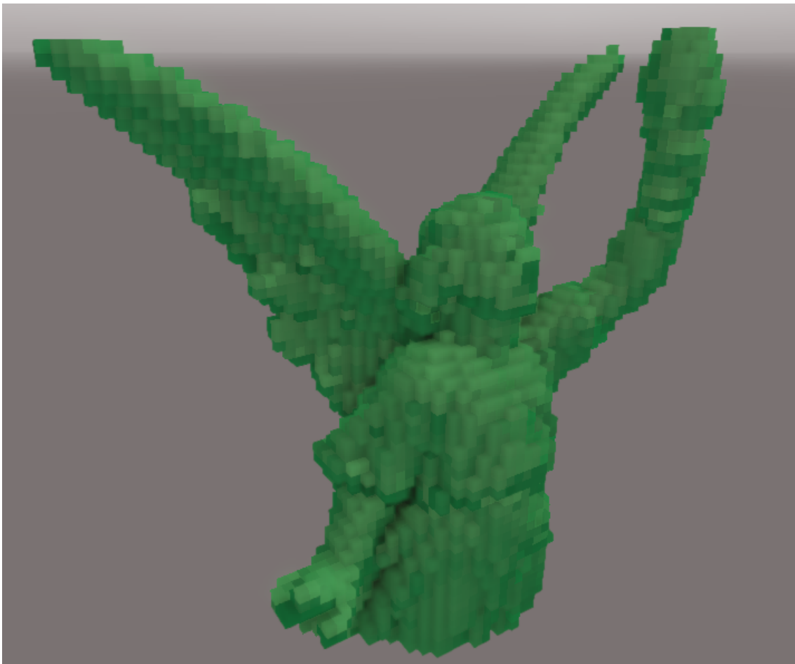
Figura 7.3: Voxelizado en CPU con una resolución 64^3 voxels
